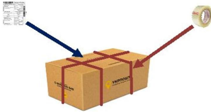
Рис.21. Зразок маркування та упакування у ящики з гофрокартону (розмір найбільшої сторони яких становить від 45 см)
